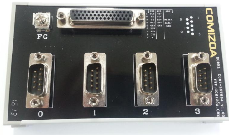
[그림 29 분기 터미널LXT618(상), LXT614(하)]
